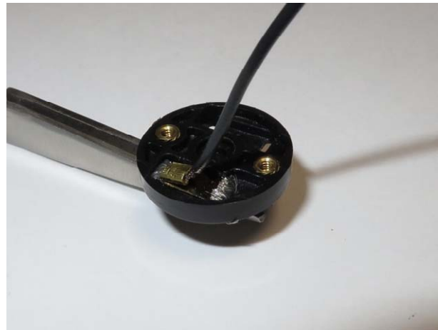
④磁石をセットした後、余分な平編み銅線をカット。 切った端を抜け防止のために磁石側へ折り曲げます。
